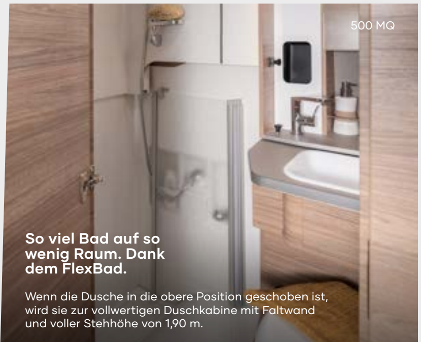
Mit wenigen Handgriffen kann die höhenverstellbare Dusche nach oben geschoben werden und die Matratze klappt zur Seite.
